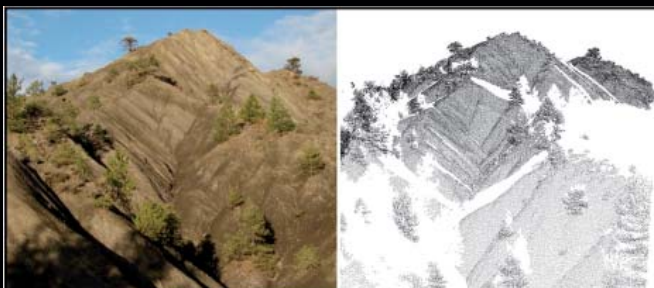
▲ À gauche : photographie panoramique ; à droite : nuage de points 3D obtenu par LiDAR terrestre.
