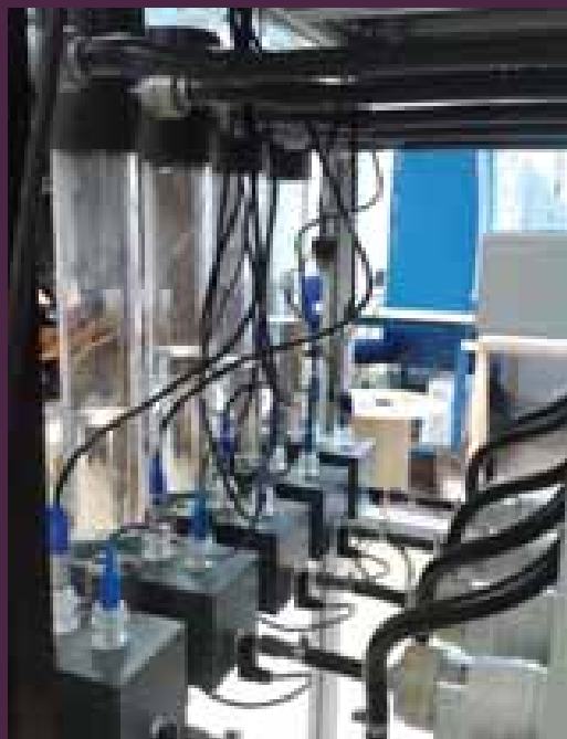
▲ Pilote d'électrodialyse de laboratoire instrumenté (suivi automatisé du pH de la conductivité et du débit).
