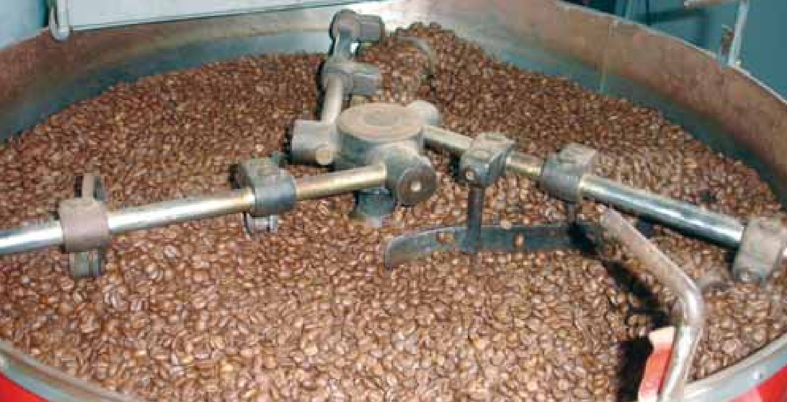
▲ Refroidissement du café après torréfaction.
