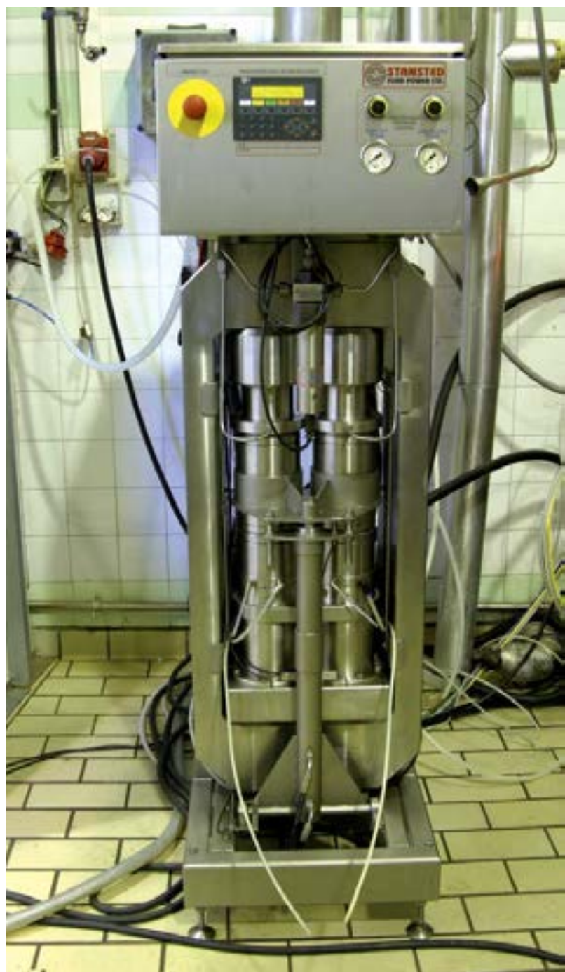
Figure 7 : Système de stérilisation et de stabilisation d'aliment liquide grâce à l'homogénéisation ultra haute pression permettant une faible consommation d'eau et d'énergie (© B. Guamis)
