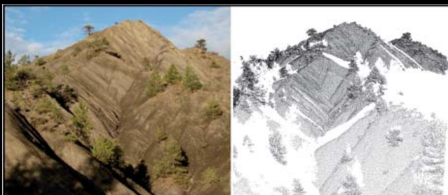
▲ À gauche : photographie panoramique ; à droite : nuage de points 3D obtenu par LiDAR terrestre.
